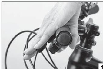
Проверьте, образует ли ваша кисть прямую линию вместе с нижней частью руки (f). Снова зафиксируйте ручки с помощью динамометрического ключа и проведите контроль посадки, попытавшись повернуть их! Тормозные ручки не должны быть намертво зафиксированы, чтобы они могли сместиться в случае падения.
