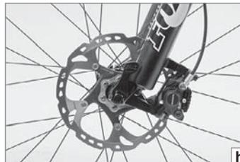
Надежно закрепленное колесо должно быть плотно зафиксировано в местах крепления рамы или вилки и не должно смещаться.
