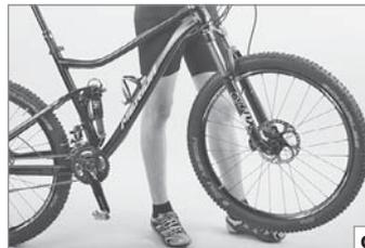
Биение при вращении может свидетельствовать о повреждениях покрышек, деформации осей или спиц. Дальнейшую информацию вы найдёте в главе «Колёса и шины» в вашем подробном руководстве по эксплуатации MERIDA и в инструкциях производителей компонентов на предоставляемом диске MERIDA CD-ROM.
